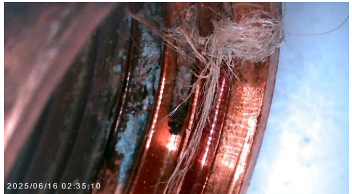
Kuva 6 Osa ollut kiinni vain kolmella kierteellä. Liittimen kierteen syvyyden näkee hapettuman alkamisesta (Tummenpi osa ollut tekemisissä veden kanssa)
