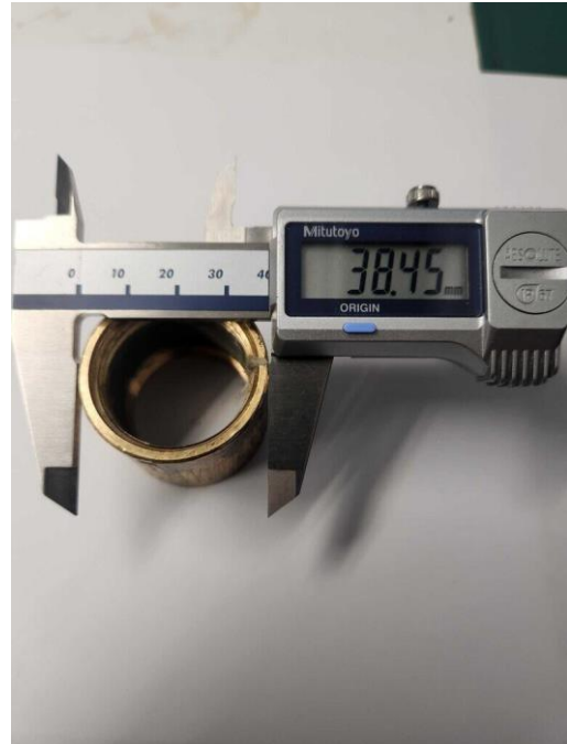
Kuva 4 Vuotanut muhvin pää 38,45 mm. Kiristyksessä liitettävä osa pellavan kanssa painanut muhvia auki, jonka jälkeen materiaali antanut periksi. Mitattu vauriopää 0,33 mm suurempi
