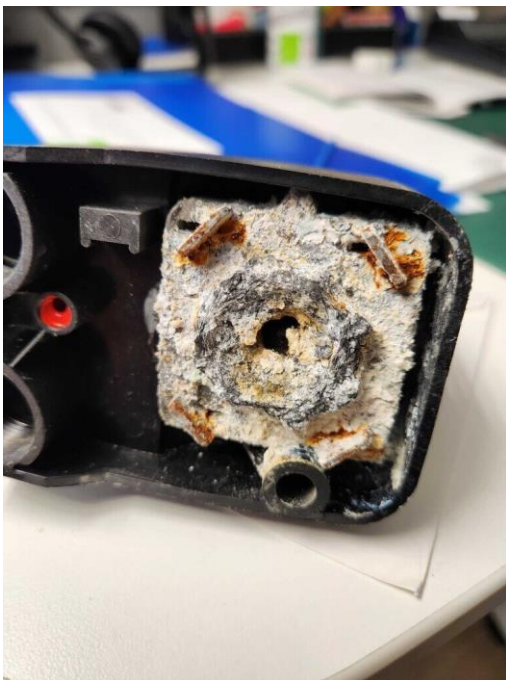
Kuva 7 Silumiinimuhvi syöpynyt pois
