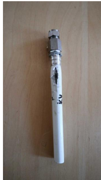
Kuva 5 Irroitettu vuotava putki
